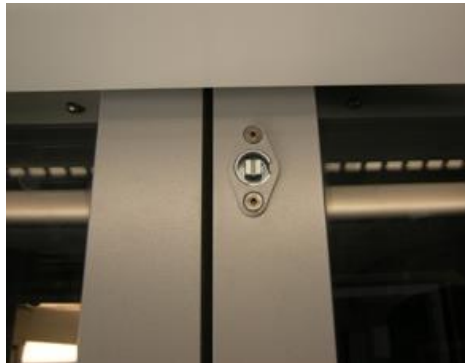
Obrázek 164 - Zajišťovací čtyřhran přechodových dveří
