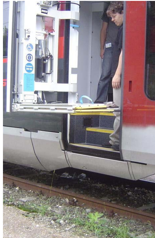
Obrázek 154 - Plošina – automatické zaklopení schodu
