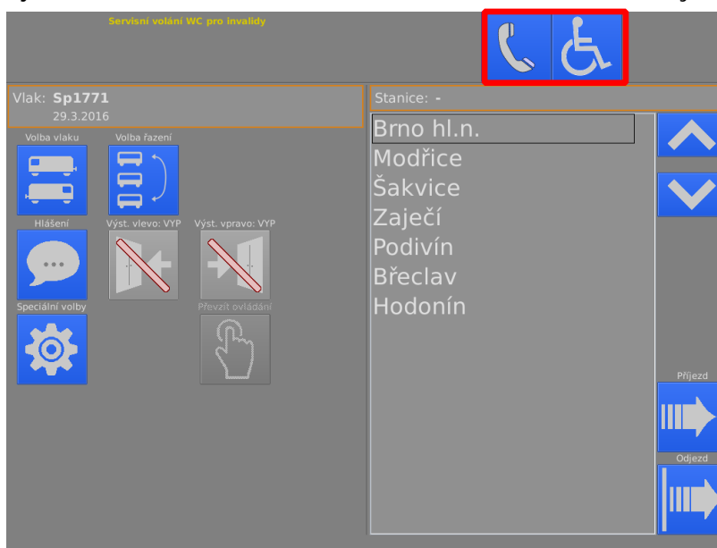
Obrázek 89 - AMiT; tlačítka volání a alarmů na úsporné obrazovce
