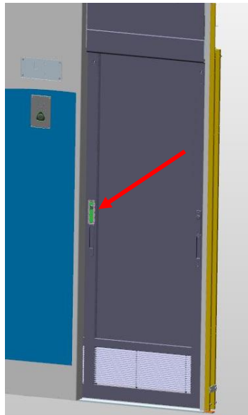
Obrázek 167 - Montážní poloha tlačítka pro otevření dveří
