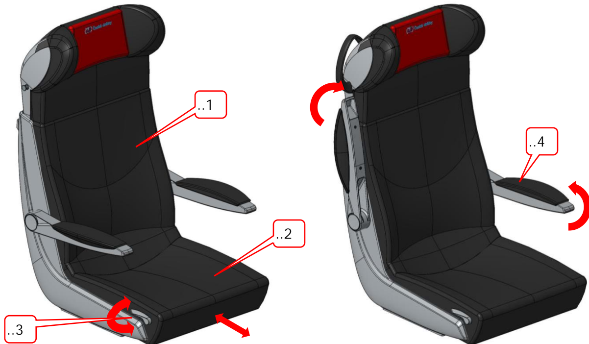
Obrázek 117 - Ovládací prvky na přední straně sedadla 1. třídy
