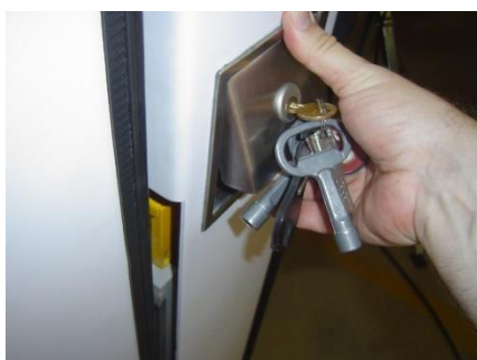
Obrázek 150 - Odjišťovací klapka zvedací plošiny v aktivovaném stavu
