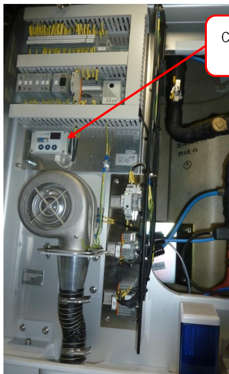
Obrázek 179 - Poloha chybového indikátoru (RS box)
