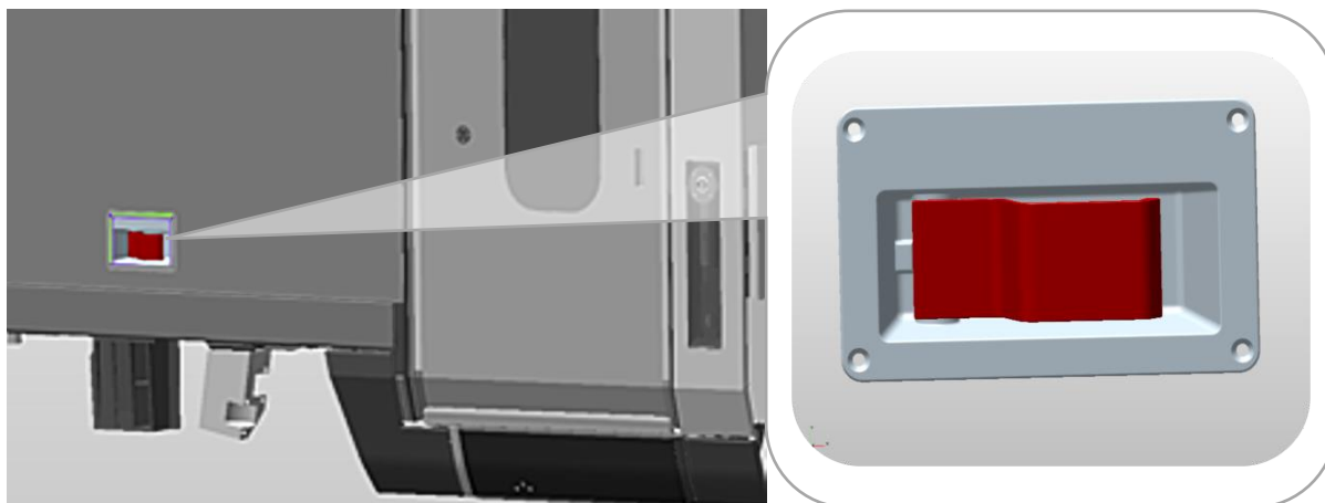
Obrázek 9 - Nouzové odemykání dveří
