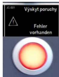
Obrázek 202 - Červené diagnostické světelné tlačítko
