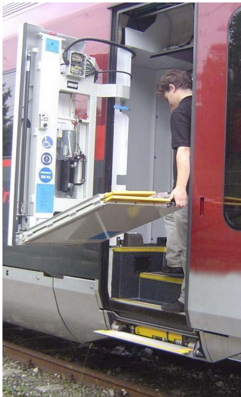
Obrázek 154 - Plošina – automatické zaklopení schodu
