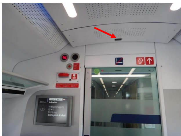
Obrázek 166 - Montážní poloha pohybového čidla, na levém obrázku na stropě (prostor pro cestující), na pravém obrázku v rámu dveří (nástupní prostor)
