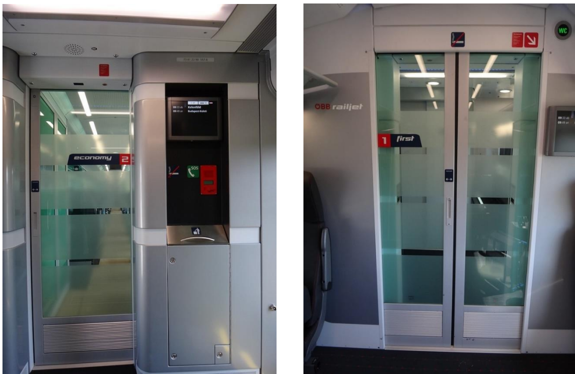
Obrázek 165 - Jednokřídlé (vlevo) a dvoukřídlé (vpravo) vnitřní dveře
