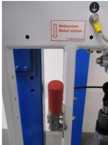
Obrázek 158 - Páka ventilu pro nouzové snižování
