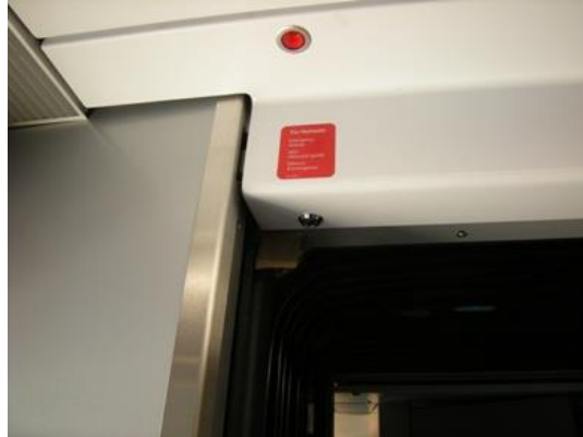
Obrázek 162 - Tlačítko nouzového ovládní a piktogram
