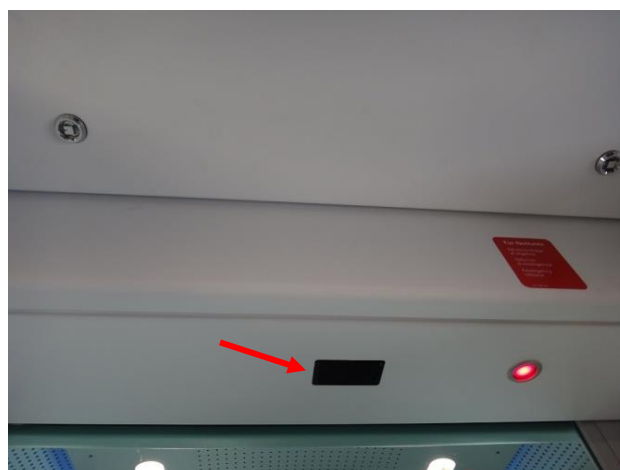
Obrázek 166 - Montážní poloha pohybového čidla, na levém obrázku na stropě (prostor pro cestující), na pravém obrázku v rámu dveří (nástupní prostor)
