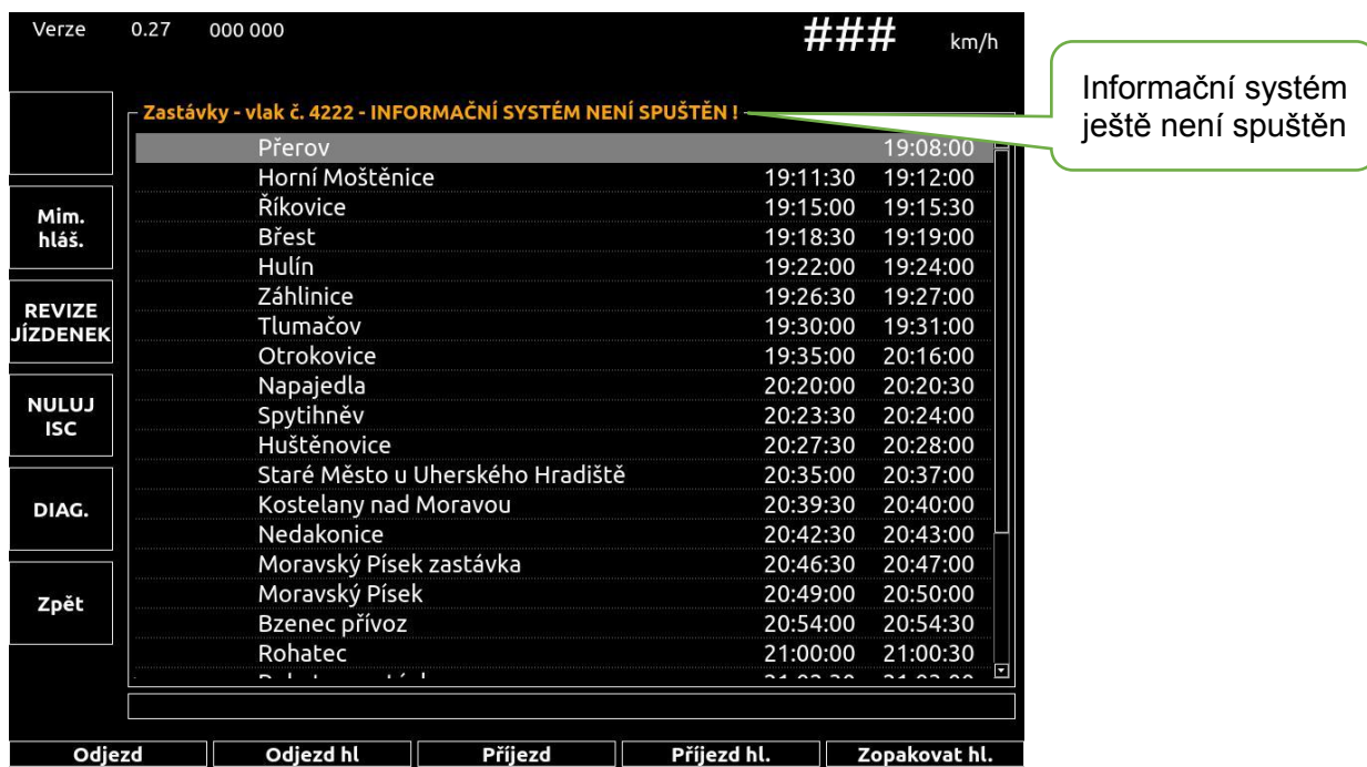
Obrázek 5: Zobrazení trasy vlaku (ISC není spuštěn)
